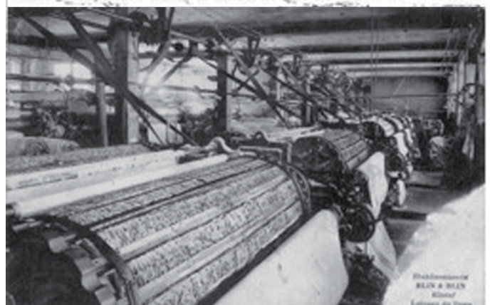
Bovenste figuur: de eerste kaardenmachine in Engeland Onderste figuur: kaardenfabriek in Elbeuf (Frankrijk)
